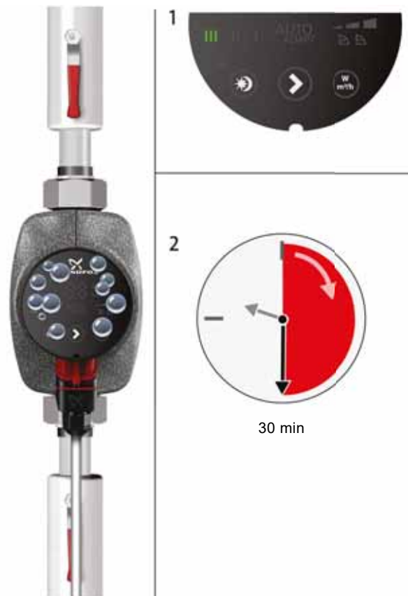
Joonis 8 Pumba ventileerimine
